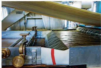
Machines - Détail de la machine Kurosu Iwano s'occupant des gestes de la fabrication des papiers faits main. Vue de la suspension fibreuse en descendant sur la toile.
