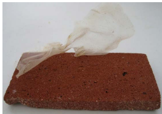
Figure 6. Fragment de brique avec une couche de gel sec complètement détaché de la surface
