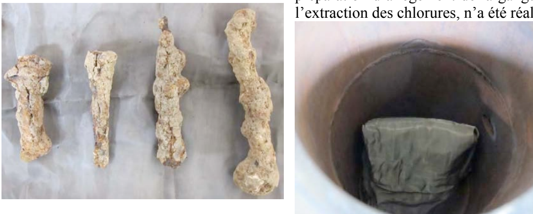
Figure 7: Clous de provenance terrestre traités par les fluides subcritiques. ©A-CORROS
