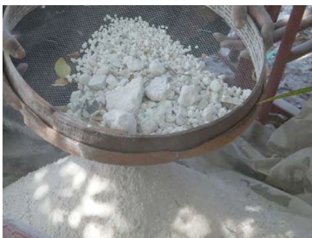
Figure 11. Tamisage de la chaux locale pour éliminer les incuits © Cnrs-Cfeetk /L. Pieri.
