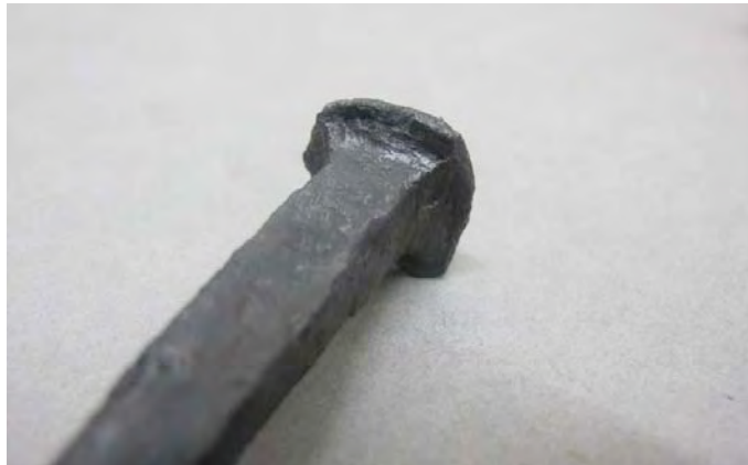
Figure 13: gangue en cours de dégagement. Observation de la présence de la gangue avec des cristaux de silice caractéristique, et présence de la surface d'origine noire mate.
