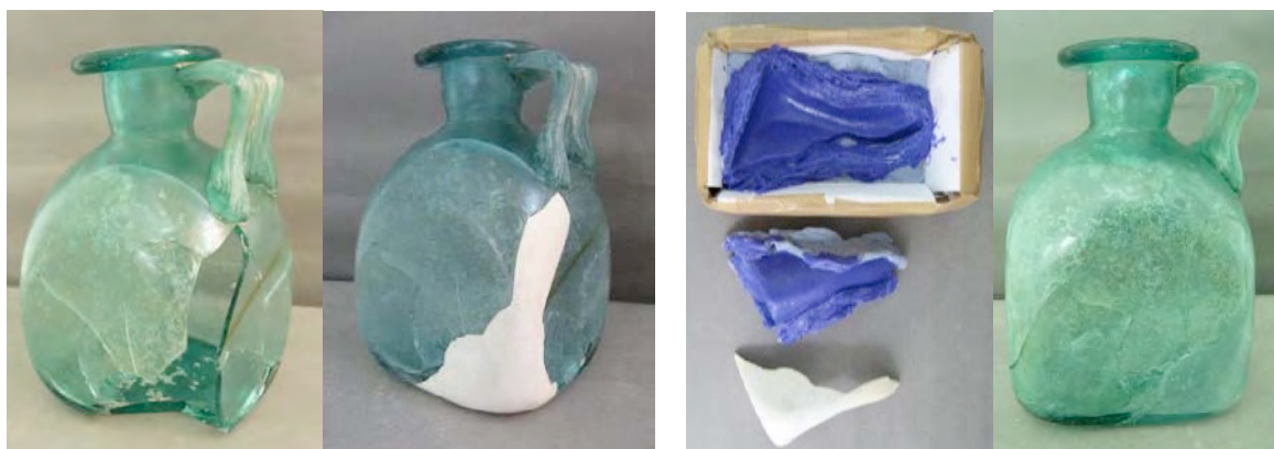
figure 12 : Comblement détachable sur une bouteille antique du Musée d'Aléria de gauche à droite : lacune avant comblement, comblement au plâtre, moulage du plâtre et tirage en résine, bouteille après comblement
