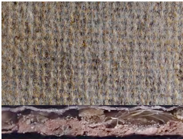
Fig. 14. Photos comparatives des renforts collés (non tissé polyester et papier japonais)
