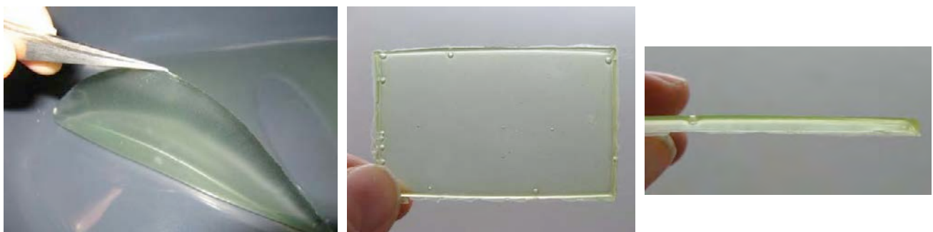
figure 13 : Fabrication des feuilles de résine acrylique
