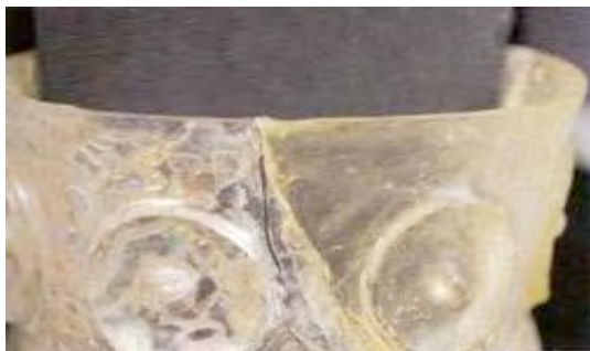
figure 10 : Résine époxydique ayant provoqué une cassure au sein du verre adjacent à la lacune. (Koob, 2006, p.49)
