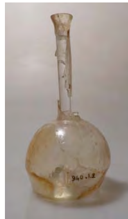
figure 11 : Comblement d'une fiole en résine époxydique très jauni datant de moins de 15 ans, Musée archéologique de Nîmes
