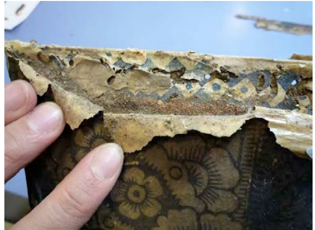
Galeries d'insectes avec sciures dans les cartons
