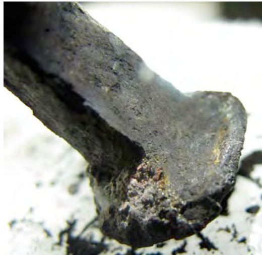
Figure 13: gangue en cours de dégagement. Observation de la présence de la gangue avec des cristaux de silice caractéristique, et présence de la surface d'origine noire mate.
