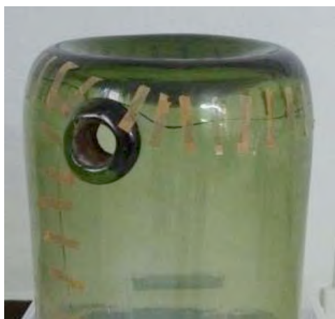
figure 4 : Collage quasi-invisible d'une bouteille en verre grâce à une résine époxydiques, Collection particulière
