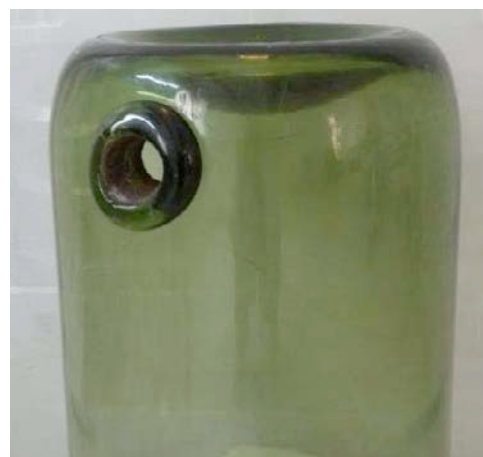
figure 4 : Collage quasi-invisible d'une bouteille en verre grâce à une résine époxydiques, Collection particulière
