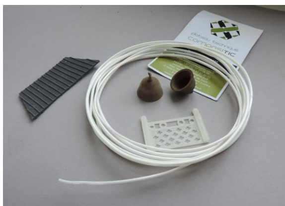
Fig. 22 : Recherche de matière (fil d'apport nacré extrudé par Compositic) et premiers essais d'impression 3D de toiture, rambarde et clochettes avec différentes résines
