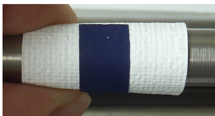
Figure 5. Essai d'adhérence d'un échantillon sur le mandrin cylindrique de \varnothing 1 cm.
