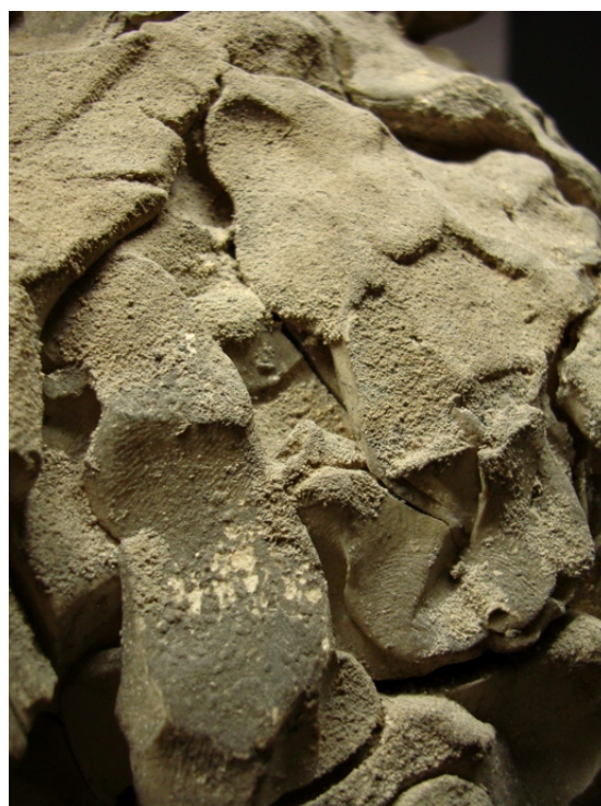
Fig.8 Détail du buste Hanako , croûtes noires épaisses
