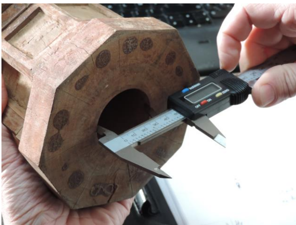
Fig.14 : Prise de mesures au pied à coulisse électronique
