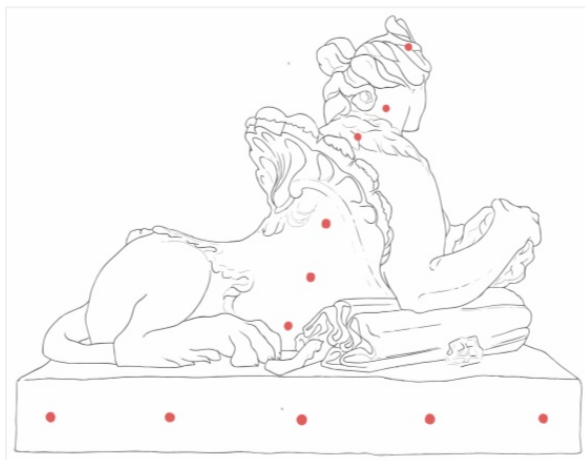
Figure 24 : Schéma indiquant le nombre et la position des anodes sacrificielles à placer dans la Sphinge sur le côté dextre. © INP/C. Brière
