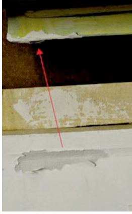
Transfert partiel du film de peinture acrylique sur la tranche d'un autre tableau.
