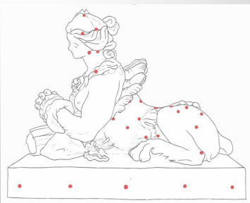
Placement des anodes côté senestre, schéma indicatif © C. Brière
